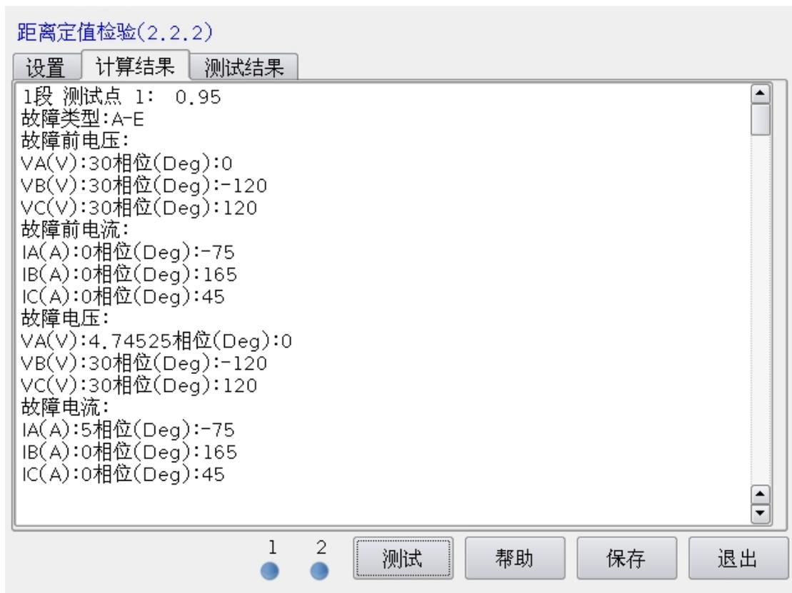
第四步：**开始测试**，按面板上的“测试”键即可进行测试；
