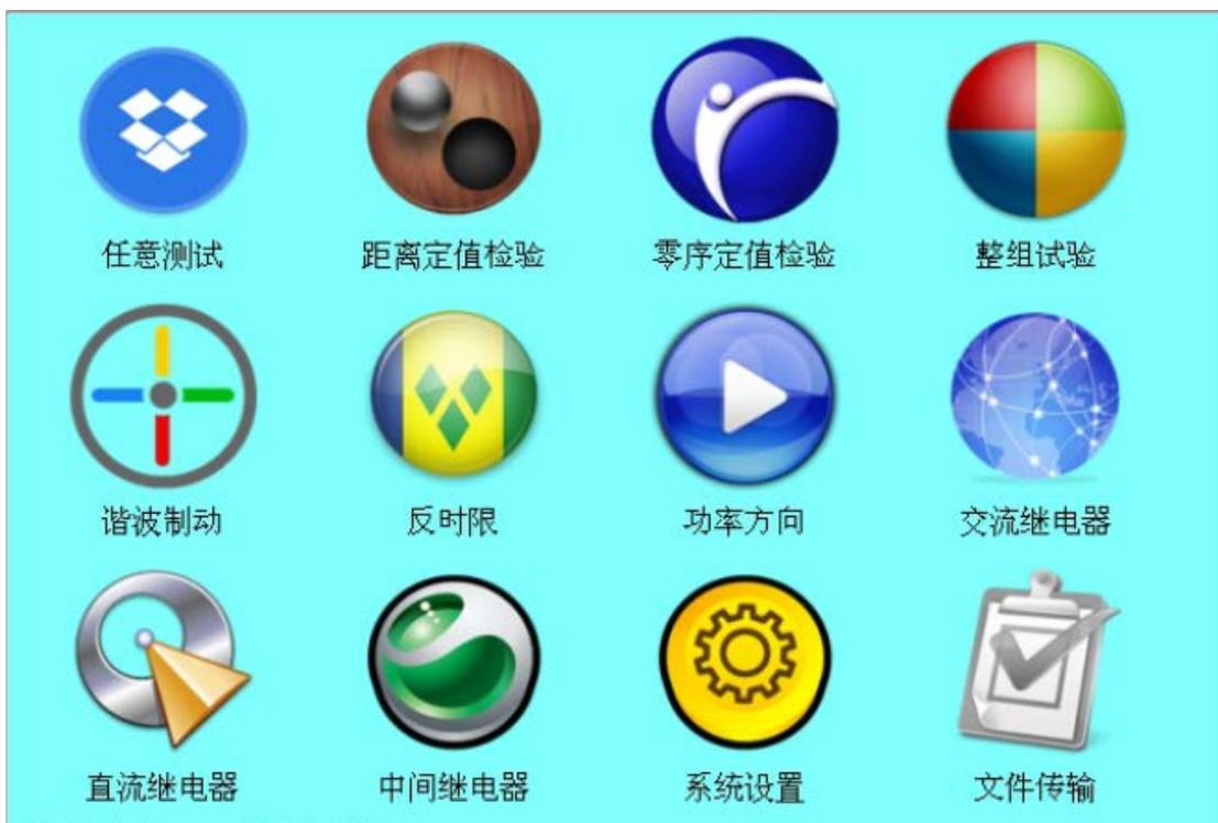
各测试模块独立，触摸或者插入鼠标点击要使用的测试模块成所有操作。(注：插入鼠标时显示鼠标光标，如果未插入光标则不显示)
